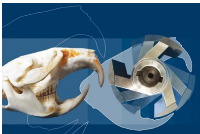
Selbstschärfende Messer: Ratten als Vorbild für Industriemaschinen
